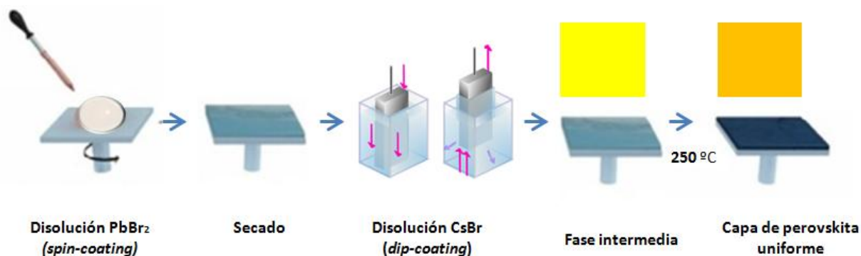
Figura 6. Esquema del proceso de deposición de la perovskita CsPbBr 3
