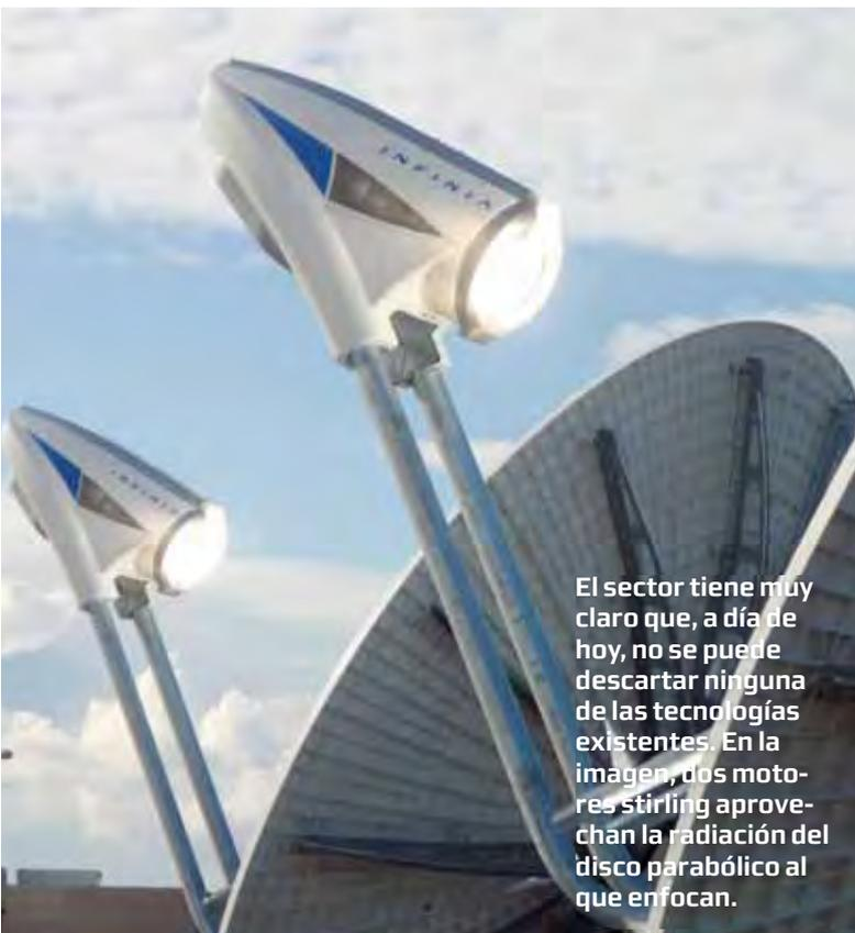
El sector tiene muy claro que, a día de hoy, no se puede descartar ninguna de las tecnologías existentes. En la imagen, dos motores Stirling aprovechan la radiación del disco parabólico al que enfocan.
