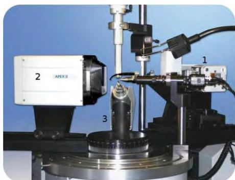
Figura 1: Partes de un difractómetro. Señaladas la fuente de radiación (1), el detector (2) y las piezas con las que se orienta el cristal (3).
