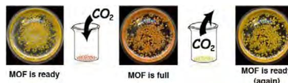
Figura 3. Esquema resumen del proceso de almacenamiento de  $\text{CO}_2$  con el indicador de pH.<sup>11</sup>
