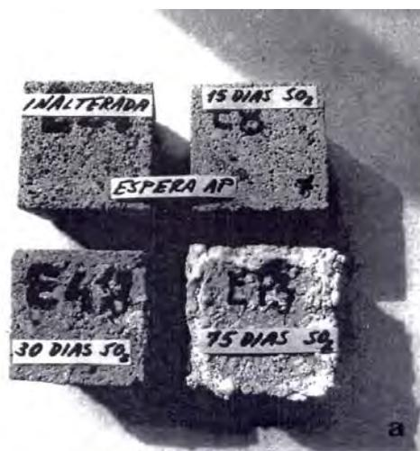
Figura 4. Muestras pétreas (probetas) sometidas a ensayo de alteración acelerada en atmósfera de  $\text{SO}_2$ . Se observa la degradación de la roca tras 75 días (Guerrero,1990).
