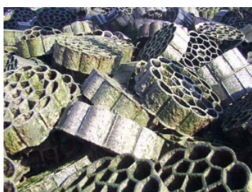
Figura 6: Soporte fijo de lecho bacteriano (CENTA, Carrión de los Céspedes).
