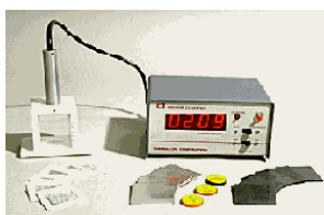
Figura 4. Contador tipo Geiger
