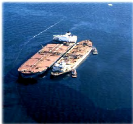
Fig. 2. Traslado de la carga del Exxon Valdez . Imagen adaptada de The Exxon Valdez Oil Spill [1]
