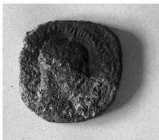
Figura 4. Limpieza láser sobre moneda de cobre revelando relieve. [7]
