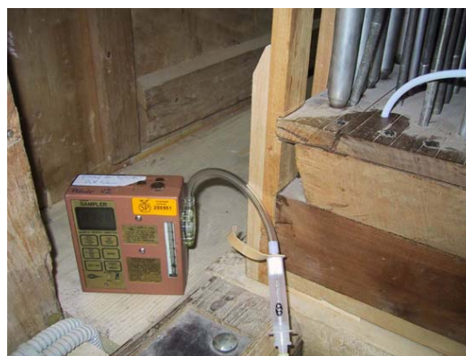
Fig. 2. Captador activo analizando el aire en el interior de un órgano. Figura extraída de la referencia [3].
