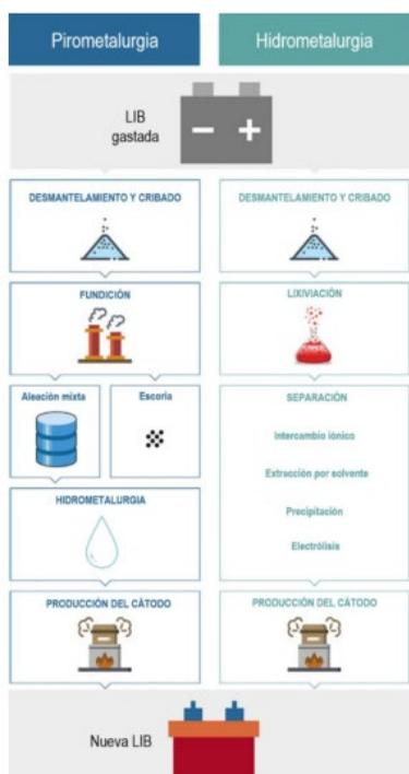
Figura 3 Pirometalurgia (■) e hidrometalurgia (■).
