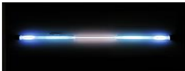
Fig 2. Tubo de descarga lleno de kriptón puro.
