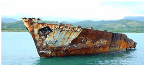
Figura 2 en la que se muestra un barco en corrosión.
