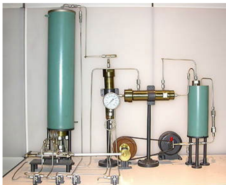
Figura 2. Diseño experimental de Fritz Haber y Robert Le Rossignol para producir amoníaco a partir de hidrógeno y nitrógeno. Este proceso tenía lugar a la izquierda [2].
