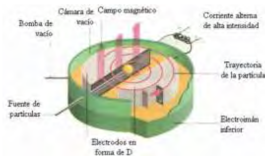
Imagen 3. Esquema de un ciclotrón con sus distintas partes 3 .
