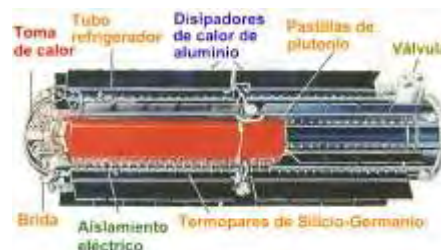
Fig.7: Representación del RTG usado en la sonda Cassini. 5
