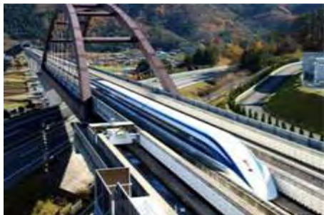
Figura 2. La imagen muestra un tren experimental de fricción 0 en Japón, construido utilizando imanes superconductores enfriados por Helio.
