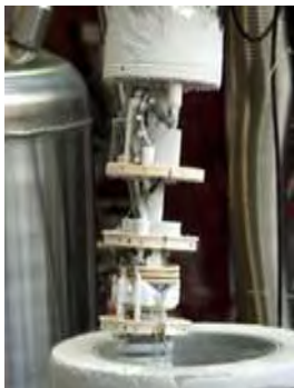
Figura 4: Detalle de un refrigerador de dilución.
