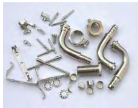
Figura 3. Ejemplos de algunas piezas que presentan una capa de níquel tras ser sometida a su electrodeposición. Podemos ver el brillo y aspecto estilizado que se consiguen con esta técnica. 3
