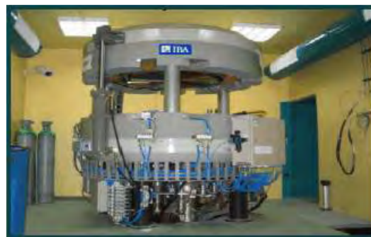
Figura 2. El Ciclotrón es un acelerador circular de partículas que consigue acelerar los iones haciéndolos girar en órbitas de radio y energías crecientes mediante la aplicación combinada de un campo magnético y un campo eléctrico variable 2 .
