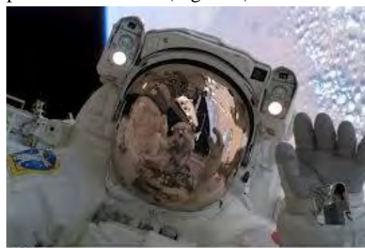
Figura 2. Podemos observar como el casco de este astronauta está recubierto por una fina película de oro.
