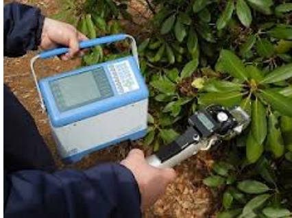
Determinación de tasas de fotosíntesis, transpiración, etc (IRGA)
