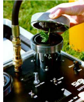
Determinación de potenciales hídricos (Cámara de presión)
