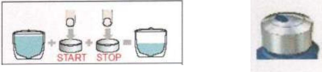
Fig. 4. Ejemplos de sistemas adicionales en inodoros: descarga interrumpible y doble pulsador.
