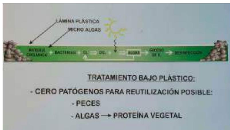
Figura 1. Esquema de funcionamiento de reactor Baccou.
