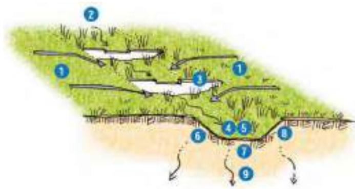
1. Escorrentía de tormenta. / 2. Máxima 5% de pendiente en el canal. / 3. Presas intermedias recomendadas para una pendiente mayor al 5% / 4. Recubrimiento recomendado: hierba de altura unos 15 cm. / 5. Altura del agua aproximadamente 2/3 de la hierba. / 6. Forma trapezoidal del canal. / 7. Ancho máximo recomendado del canal 3 m / 8. Pendiente lateral máxima 3:1 (H:V) / 9. Infiltración cuando sea posible.
