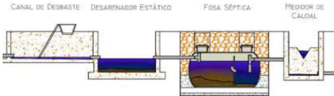
Figura 2: Diagrama de flujo de una fosa séptica. (Cedex, 2010)
