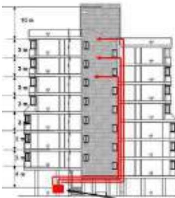
En la actualidad, el agua se impulsa de forma diferente en cada bloque. En los de 7 plantas, se impulsa a 60 m.c.a.; y, en los bloques de 10 plantas a 65 m.c.a., siendo la altura de estos bloques de 25 metros y 34 metros respectivamente.
