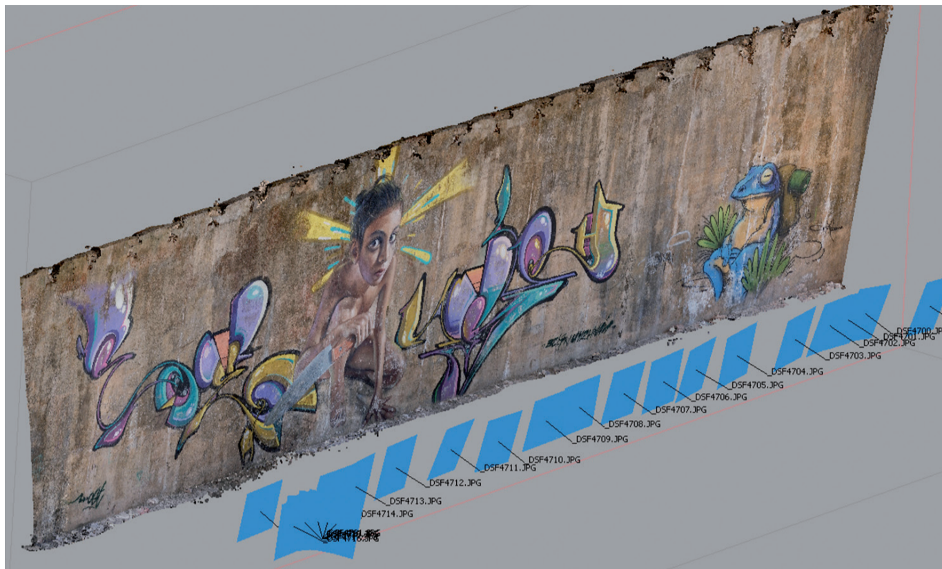
Fig. 1. Modelo tridimensional en un plano mediante proceso fotogramétrico con Agisoft Photoscan de obras de gran tamaño ubicadas en la Fundación La Cruz de Linares dentro del Proyecto "Pintado en la pared". Estudio de la pintura sobre muro en la provincia de Jaén en los siglos XX-XXI" (© Carmen Moral Ruiz)
