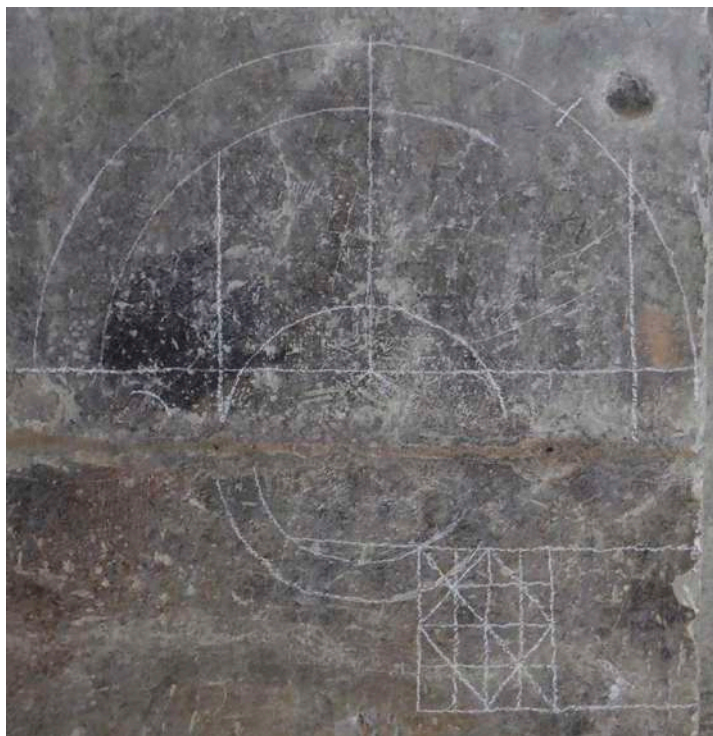
Fig. 8. Monteas n° 4. Arco o bóveda, arco de medio punto invertido y alquerque. Fotografía de la autora.
