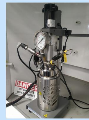
Reactor Parr de 600 mL empleado en los ensayos de pasteo
