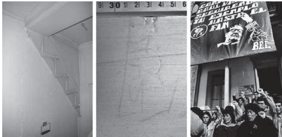
Figura 6. Resultados de la prospección muraria en el sitio de memoria Londres 38, mediante reflectografía IR. Izquierda: La flecha indica la zona de captura en el cielo del recinto (izquierda). Centro: Detalle del escrito subyacente encontrado, en el que se distingue la letra "E" (centro) (Archivo Fotográfico CNCR. Correa, C. 2011). Derecha: Analogía gráfica determinada a partir de los testimonios de ex-militantes del Partido Socialista, que permitieron presumir que estarían vinculados a la brigada muralista Elmo Catalán (Fotografía de Cáceres, JC. 1988).
