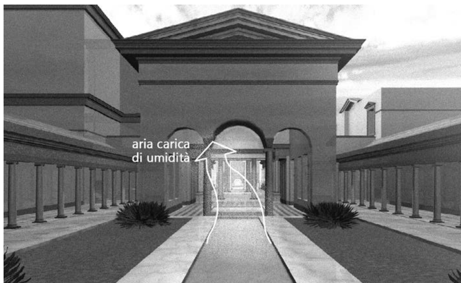
Fig. 4. Ricostruzione virtuale dell'area del Giardino-Stadio, vista della corte nord e indicazione del sistema di raffreddamento evaporativo indotto dalla vasca nel settore settentrionale (autore).
