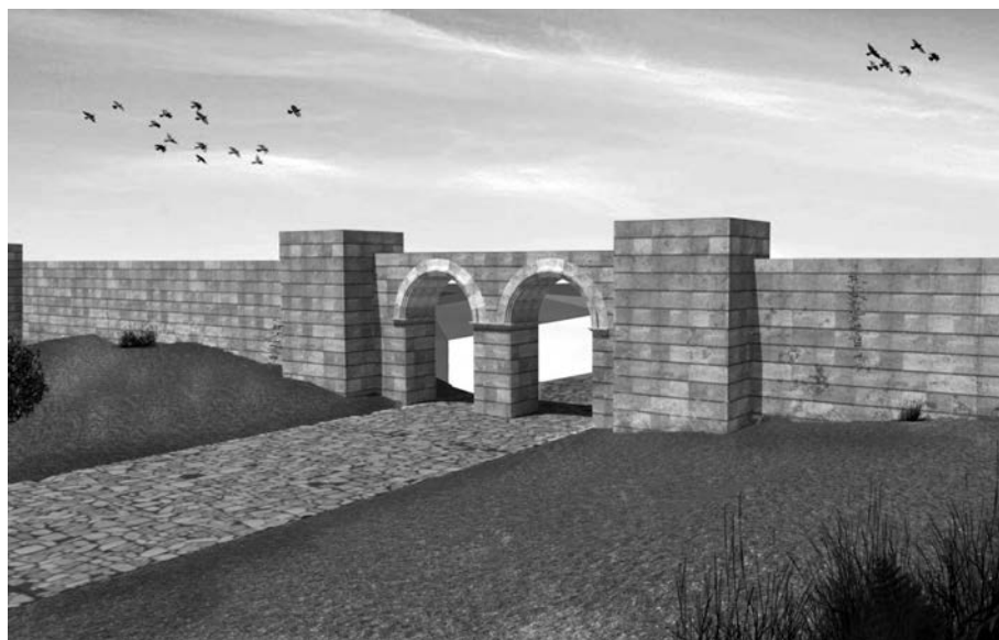
Fig. 12. Hypothèse de reconstitution de l'utilisation des blocs en vousoir dans une entrée de la ville (reconstitution Juan de Dios Borrego).
