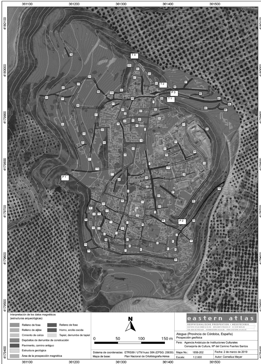
Figura 8. Localización de las puertas de acceso al interior del recinto amurallado de Ategua, localización de los edificios singulares e identificación y denominación de las calles y/o caminos interpretados a partir de los datos obtenidos por la prospección geofísica. ©M a del Camino Fuertes Santos.
